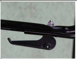
8. 上下扶手连接完毕后压紧扳手的状态。
