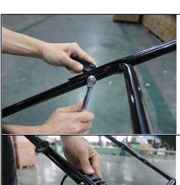
7. 用压紧扳手将上下扶手连接起来。
