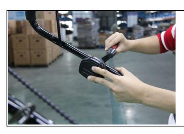
13. 将油门开关固定到上扶手左侧。
