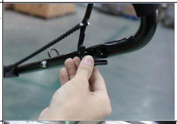
10. 将熄火线穿入熄火操纵杆 孔中,然后将熄火操纵杆插入 上扶手上对应孔位(上扶手右 侧靠下的孔)。
