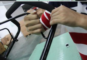
11. 将熄火操纵杆孔另一头插 入上扶手左侧靠下孔位。
